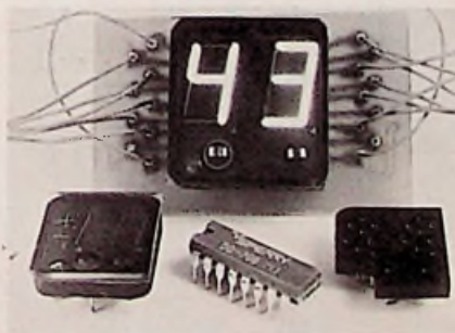
De SP-752 ouder test. Op de voorgrond de SP-731 met decoder en insteekvoet.
