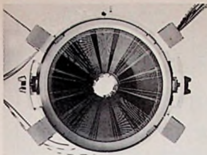
Fig. 3. Precisie-Static-Toroïdspool. De kleefnokken sluiten verdraaiing tijdens het transport uit.
